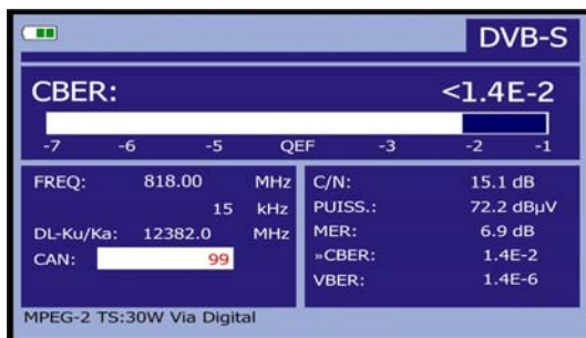
Figure 34.- Écran de mesure du CBER de signaux modulés en QPSK .
