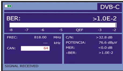
Figura 29.- Pantalla de medida del BER de señales moduladas en QAM .
