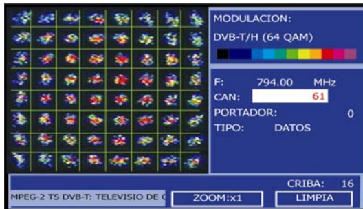
Figura 41.- Diagrama de constelación. Señal DVB-T/H (QAM 64).
