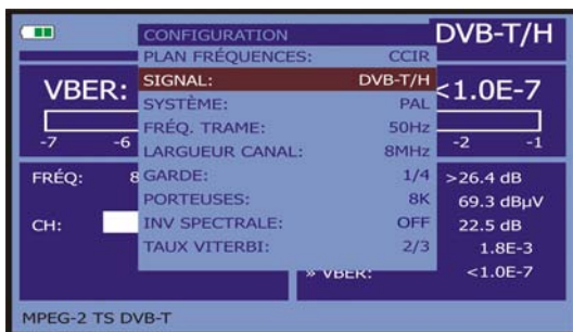
Figure 20.- Écran de configuration de mesure de signaux modulés en COFDM.
