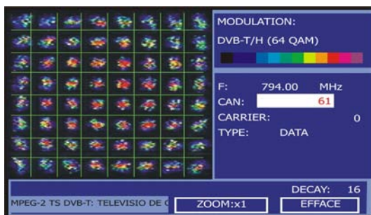
Figure 41.- Diagramme de constellation. Signal DVB-T/H (QAM 64).
