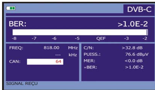
Figure 29.- Écran de mesure du BER de signaux modulés en QAM .
