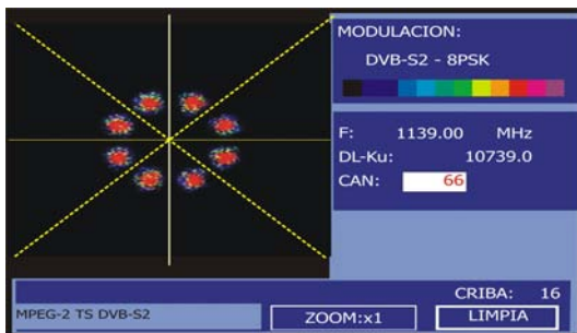
Figura 45.- Diagrama de constelación. Señal DVB-S2 (8PSK).
