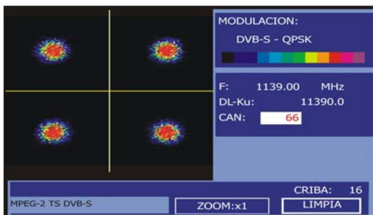
Figura 44.- Diagrama de constelación. Señal DVB-S (QPSK).
