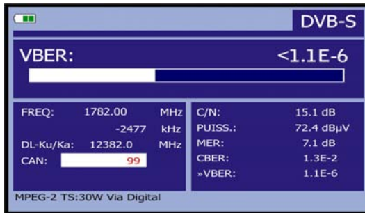
Figure 36.- Écran de mesure du VBER de signaux modulés en QPSK . (DVB-S).
