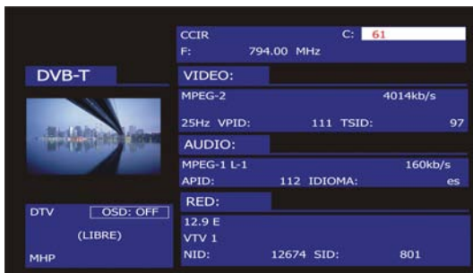
Figura 66.- Visualización de un canal digital.
